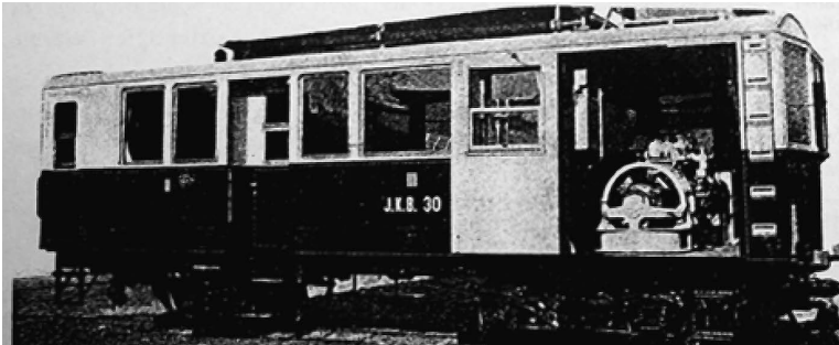
Lokomotyvas, 1908–1930 m. važinėjęs su benzoelektrine pavara Pagėgių–Smalininkų ruože. H. E. von Knobloch. Die Wischwiller Dorf-Chronik II, Berlin-Dahlem, 1998, S. 32
