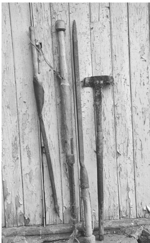
Savadarbiai kalvio įrankiai: replės karštam metalui laikyti, žymeklis, trys variniai litavimo plaktukai, replės. 2013 m. S. Aliukonio nuotr.
