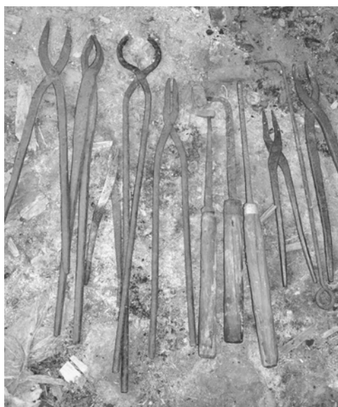
Savadarbiai kalvio įrankiai: replės karštam metalui laikyti, žymeklis, trys variniai litavimo plaktukai, replės. 2013 m. S. Aliukonio nuotr.
