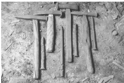
Savadarbiai metalo kirstukai ir dornikai angoms iškalti. 2013 m. S. Aliukonio nuotr.
