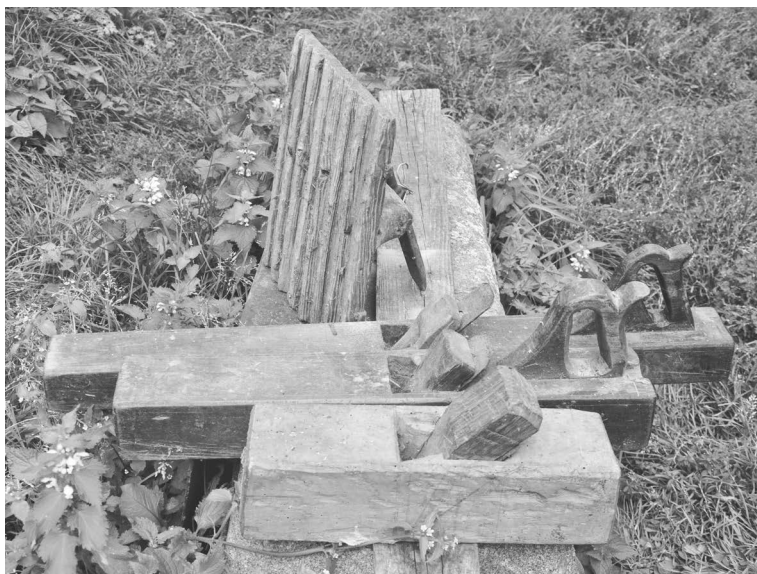
Senelio Kipro Aliukonio staliaus darbo įrankiai: oblius, du laistuvai, šiaudinio stogo dengimui naudojama lentelė. 2013 m. S. Aliukonio nuotr.
